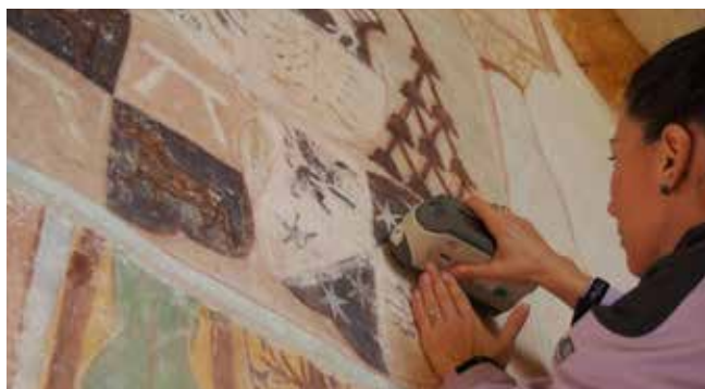
Slika 3 Ugotavljanje barvnih sprememb na stenski poslikavi s kolorimetrijo po utrjevanju (foto: Anka Batič)
