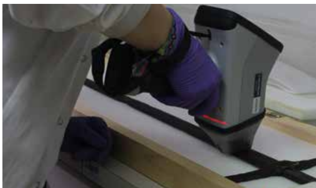
Slika 1 XRF analiza sestave srednjeveškega meča (foto: Eva Menart)
