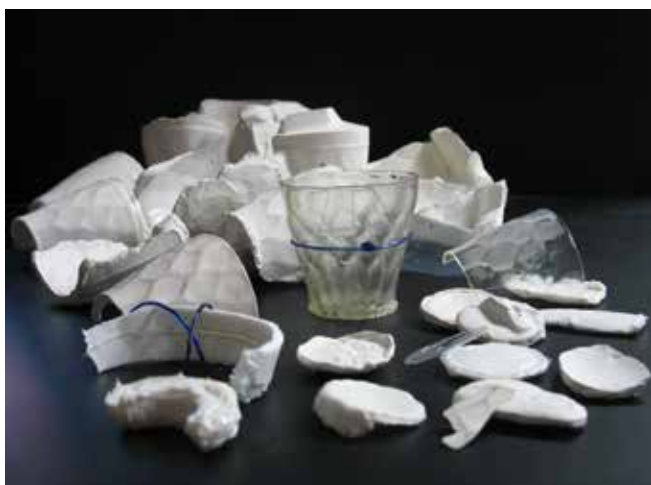
Slika 8 Število kalupov, potrebnih za dopolnitev zahtevnejšega steklenega predmeta (foto: Gorazd Lemajič)
