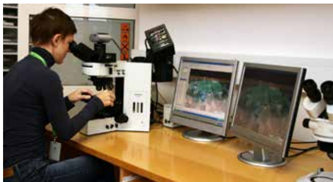
Slika 1 Preiskave stratigrafije barvnih plasti z optično mikroskopijo (foto: arhiv ZVKDS, Valentin Benedik)
