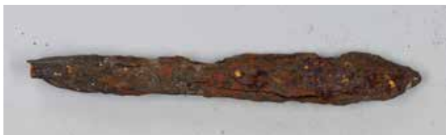
Slika 1 Arheološko železo, ki še ni bilo v konservatorsko-restavratorskem postopku, zaradi aktivne korozije propada. Propadanje lahko upočasnimo s hrambo pri čim nižjem RH, blizu 0 % (foto: Eva Menart)
