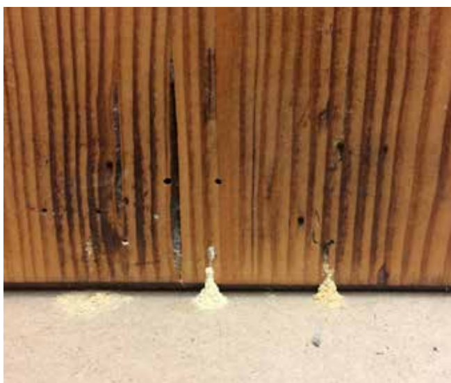
Slika 5 Poškodbe na lesenem predmetu kot posledica delovanja škodljivcev (foto: Eva Menart)
