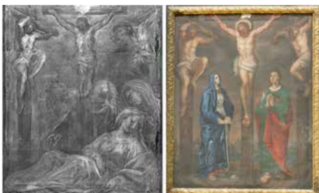
Slika 1 Rentgenogram (levo) in fotografija slike (desno), kjer smo s pomočjo radiografije ugotovili, da je bila pod vidno sliko ( Križanje ) naslikana povsem drugačna podoba ( Pieta ) (foto: Sonja Fister)
