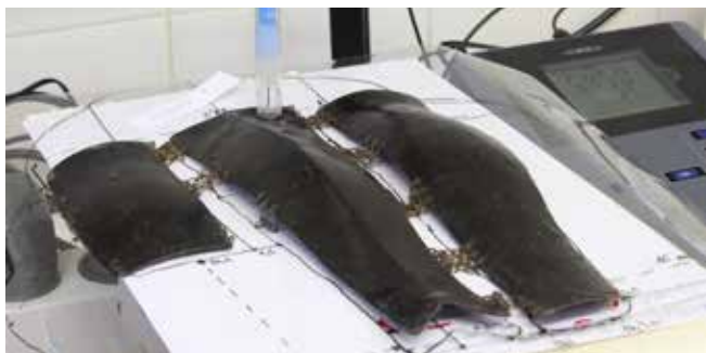
Slika 3 Meritev površinskega pH japonskega laka uruši (foto: Nataša Nemeček)
