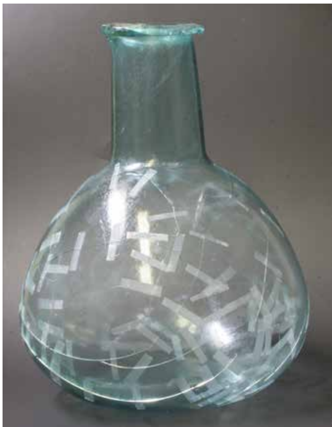
Slika 6 Začasno sestavljen stekleni predmet z matiranim lepilnim trakom pred lepljenjem (foto: Gorazd Lemajič)
