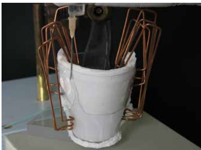
Slika 7 Vbrizgavanje smole za dopolnjevanje v prozorni kalup, pritrjen s kovinskimi sponkami (foto: Gorazd Lemajič)
